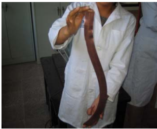
Fig. 1. Perfil curvo por rodillos desalineados.
